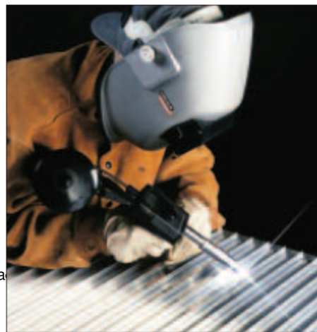
La pistola de carrete Magnum® SG es una excelente opción para la soldadura de hoja de metal de aluminio.
